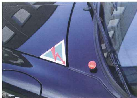
Akkurat im Haubenwinkel platzierter Aufkleber: Der Kabelsatz für den Stromkreisunterbrecher war ab Werk vorbereitet
