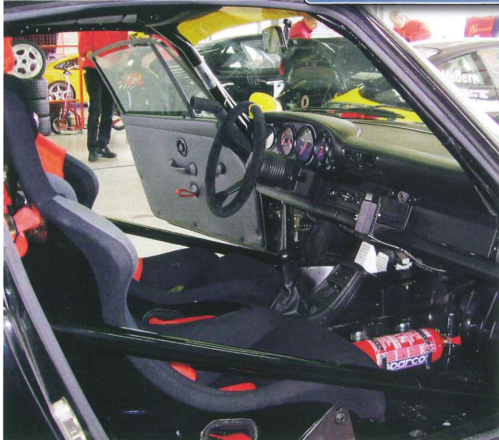
Seitenaufprallschutz: Typisch für den geschweißten Matter-Käfig war diese ansteigende Verstrebung der Türausschnitte
