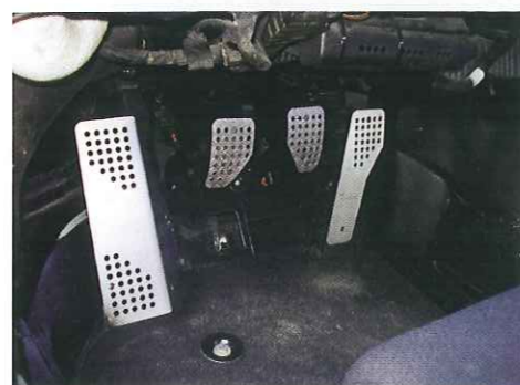
Professionell gestalteter Fußraum: statt Riffelblechen eine schlichte MDF-Platte, dazu Aluminium-Pedale und Fußstütze
