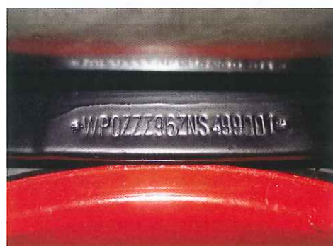
Unter dem Tank eingestanzt: Die Fahrgestellnummer ist nur auf dem Typenschild im Kofferraum dokumentiert worden
