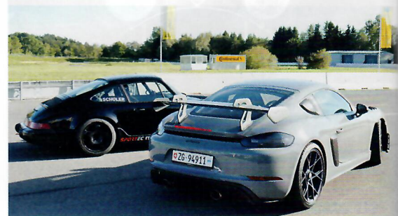
Verstellbarer Heckspoiler mit Schwanenhals-Anbindung.
