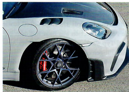
Leichte Aluminium-Schmiederäder mit Zentralverschluss, indigoblau lackiert.
